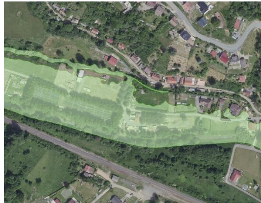
Obrázek 23 zaplavené zahrady a RD v Městečku již při Q_5 , ř. km 5,40 – 5,10
