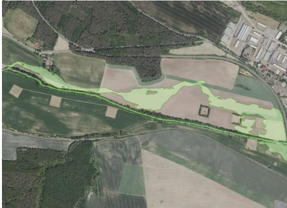
Obrázek 20 po vyběžení Q 5 nad Rakovníkem povodeň kopíruje trasu původního koryta Rak. potoka
